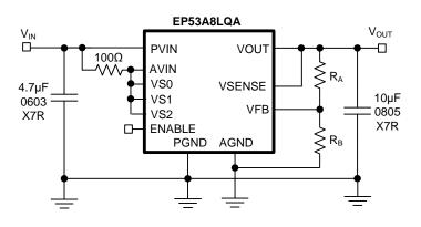
$V_{OUT} = 0.6V \left(1 + \frac{Ra}{Rb}\right)$
